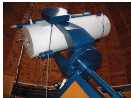
40 cm zrkadlový ďalekohľad so sprievodným 11 cm refraktorom v hlavnej kupole hvezdárne (od roku 2004).
