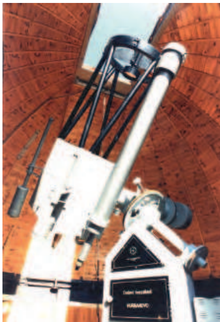
40-cm ďalekohľad typu Cassegrain od firmy Gajdušek-Kozelský, spojený so 120-mm refraktorom.
