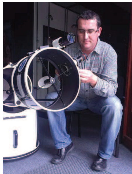
Justáž ďalekohľadu typu Newton, po obnove povrchu jeho optiky (František Takács).
