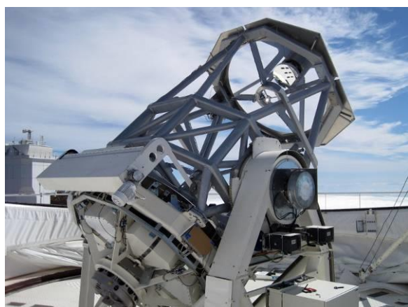
Obr. 9. GREGOR na Observatorio del Teide je vybaven spektrografem GRIS pro IR oblast a úzkopásmovým laditelným filtrem GFPI pro viditelný obor.
