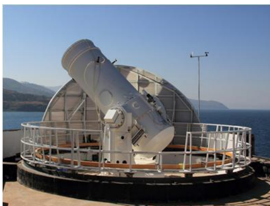
Obr. 8. New Vacuum Solar Telescope (NVST) na Yunnan Observatory slouží k přímému zobrazování a spektroskopii v blízké IR oblasti.
