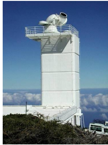
Obr. 5. Swedish Solar Telescope (SST) na Observatorio del Roque de los Muchachos je jediným refraktorem mezi velkými slunečními dalekohledy. Napájí spektrograf TRIPPEL a úzkopásmový laditelný filtr CRISP.
