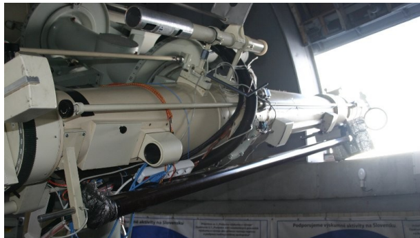
Obr.5: Pôvodný a nový pointer (pointer R) na pravom koronografe. Pôvodný pointer využíval len malý tubus upevnený na koronografe blízko deklinačnej osi montáže (tenká rúra nad telom koronografu). Objektív nového pointra vidieť umiestnený pred hnedou rúrou pointra (na obrázku vpravo) v strede cloniackej plochy. Diódy sú umiestnené na konci tejto rúry (vľavo dole).
