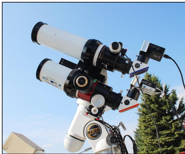
Obr. č. 2. Dvojice dalekohledů na pozorovací plošině odborného pracoviště je určena pro celkové snímky Slunce v čáře H \alpha a CaII K.
