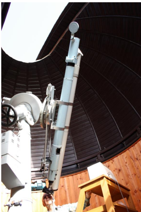
Obr. č.15 :Fotografovanie protuberancií koronografom Lyottovho typu v Heyde kopule.
