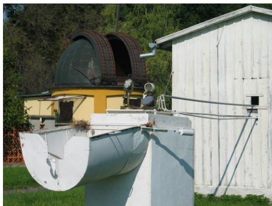
Obr. č.19: Heliostat a šosovka (100/5000mm) spektrohelioskopu Hale-ho typu v Hurbanove. V pozadí je obnovená budova Heyde kopule.
